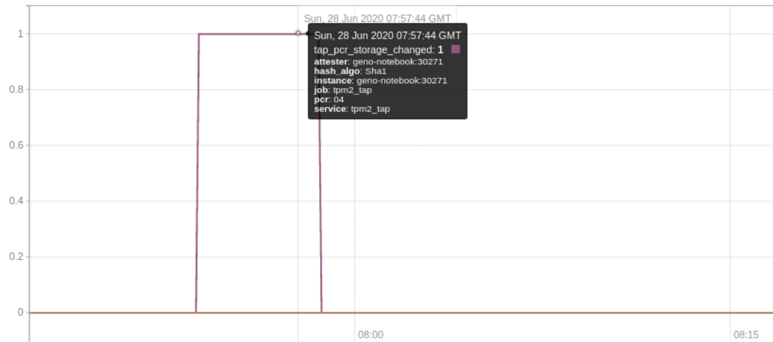
Abbildung 5.2: Ergebnis des Monitoringsystem durch Prometheus visualisiert (Änderung des Wertes einer PCR-Bank)
